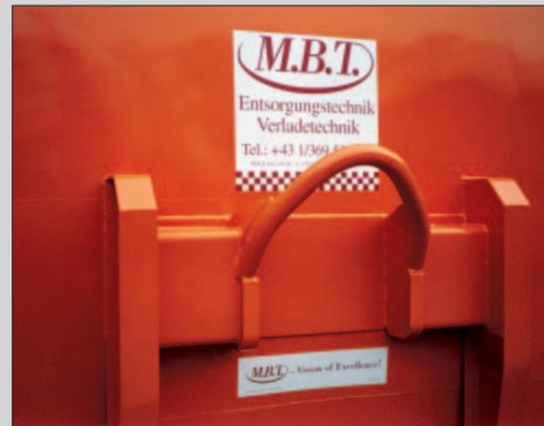
Aufnahmebügel bei Entleerklappe verstärkt.
